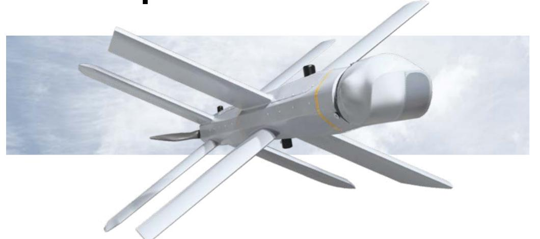
Новое интеллектуальное многозадачное оружие, которое способно самостоятельно находить заданную цель и поражать ее. В состав комплекса входят высокоточный ударный элемент, модули разведки, навигации и связи. ZALA ЛАНЦЕТ формирует собственное навигационное поле и не требует создания наземной или морской инфраструктуры.
